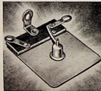
Bild 2. Der Typ 4 JA 2 A 4 ist auf einer Kühlfläche montiert. Bei 400 V Sperrspannung verträgt er 500 mA Durchlaßstrom
